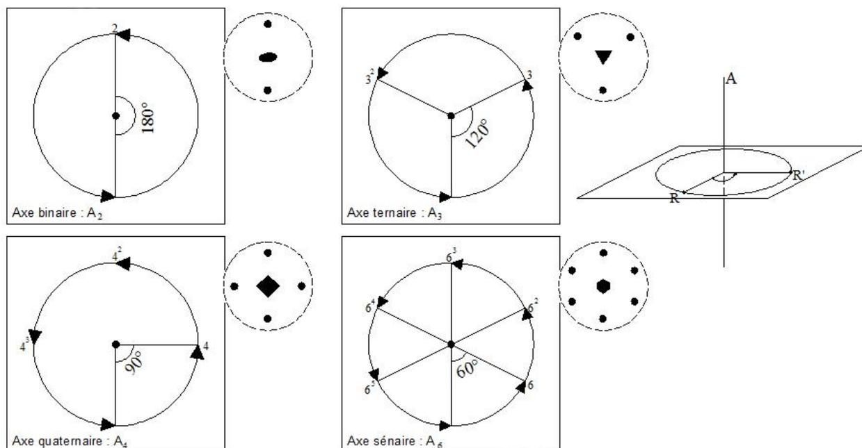
**Figure. 24 : Représentation de la symétrie par rotation (Sens trigonométrique)**
