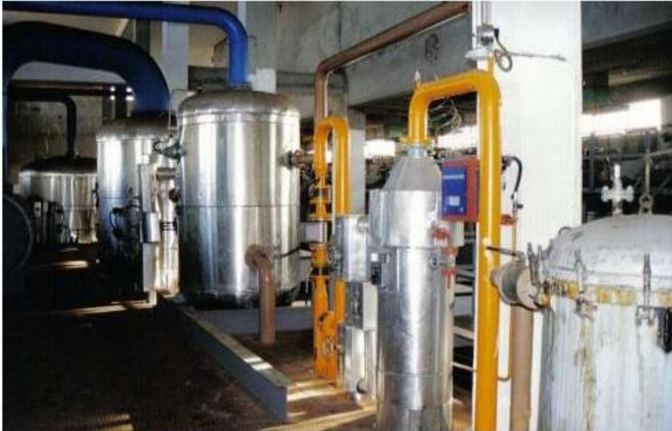
**Figure3** : Filtre à pression à cadres verticaux
