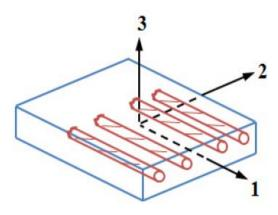
Le pli composite unidirectionnel est considéré comme un matériau orthotrope
