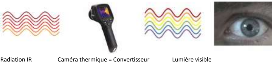
Figure 11-3 : Conversion du rayonnement infrarouge en lumière visible
