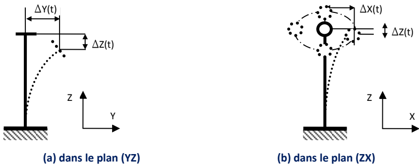
Figure 4-18 : Flexion pure des paliers
