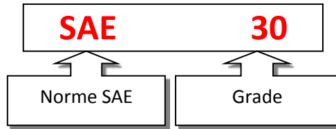
Figure 5-1 : Désignation des huiles mono grade SAE
