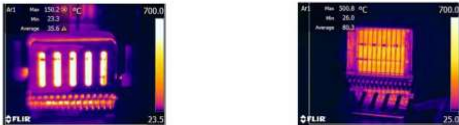
Figure 11-9 : Phénomène de saturation
