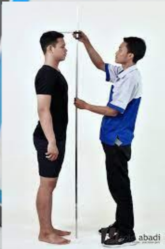
قياس الطول بجهاز الأنثروبومتر Anthropometer
