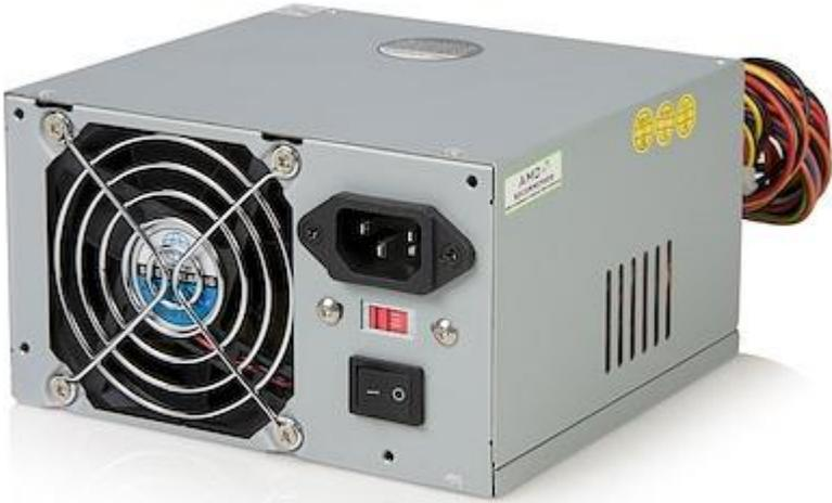
علبة التغذية هي مجموعة من المكونات الالكترونية التي تعمل على تحويل التيار المتناوب (220/110 فولط) الى تيار مستمر (12 فولط) لتغذية اللوحة الام بالتيار الكهربائي
