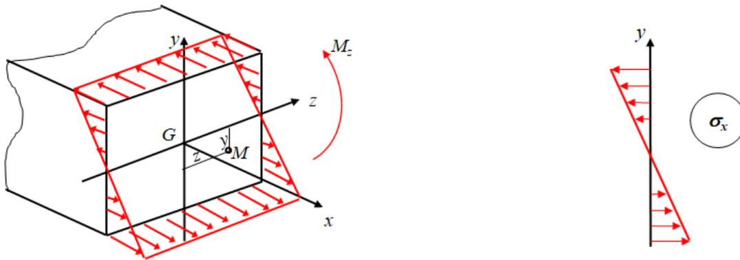
Figure 9 : Distribution des contraintes normales  $\sigma_x$  dans la section
