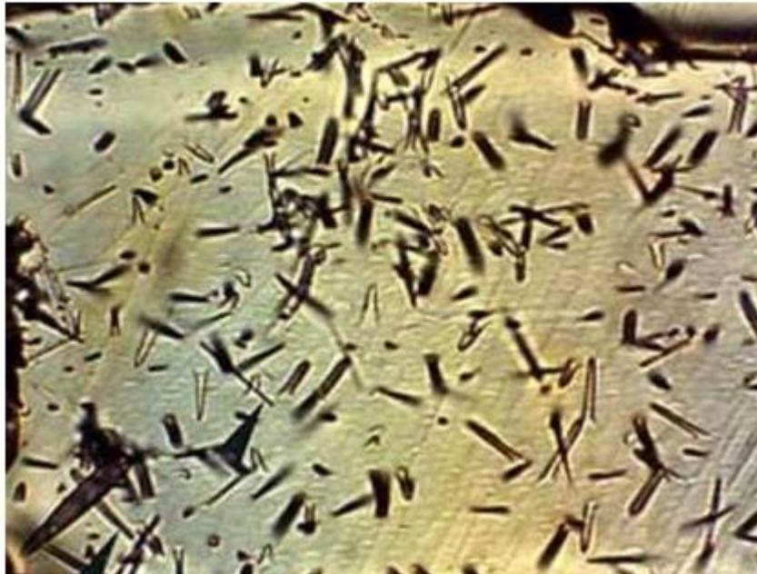
Traces de fission révélées dans un minéral observé au microscope optique.
