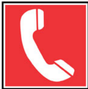
Téléphone pour la lutte contre l'incendie
