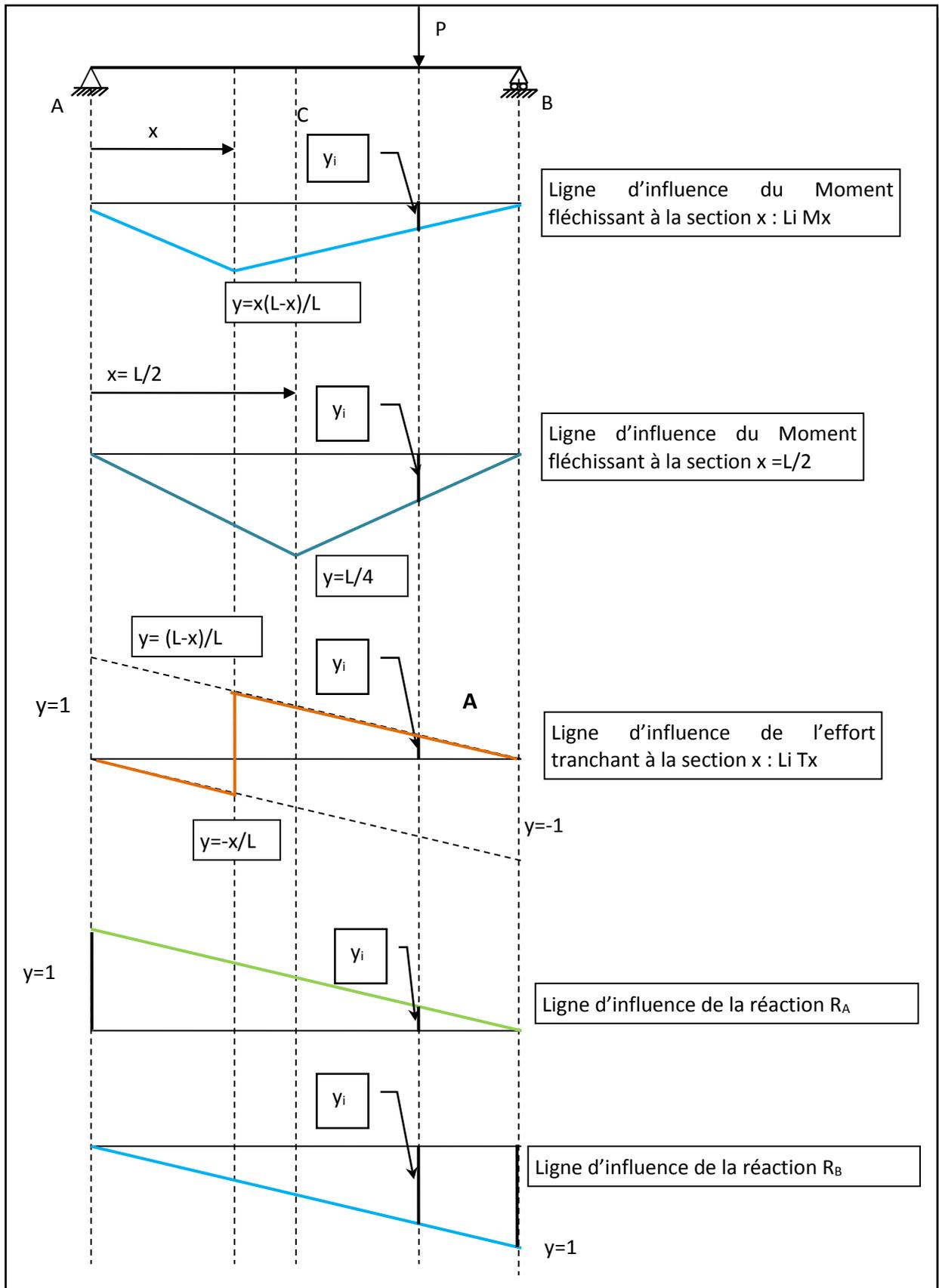
Figure 6-2 : Les lignes d'influence d'une poutre isostatique
