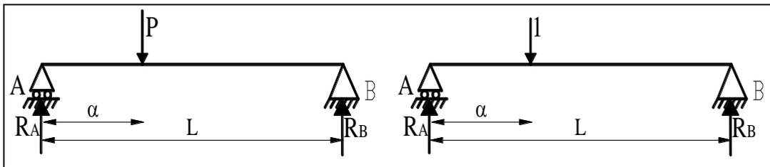
Figure 6-1 : Schéma statique de la poutre isostatique
