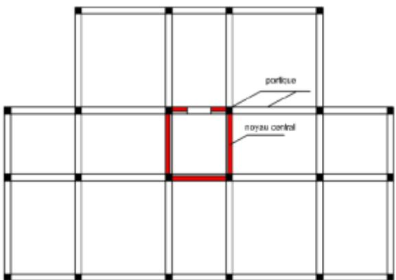
2) structures à noyau central, formé de deux murs couplés à chaque étage par des poutres et qui assure la résistance aux forces horizontales.
