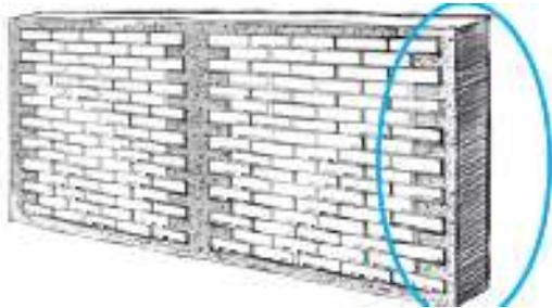
Le principe de maçonnerie chaînée exige que les murs soient construits avant les poteaux. D'une façon à permettre au béton de s'insérer dans les découpures du mur de maçonnerie.
