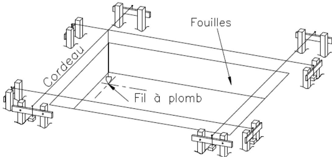
Les points d'axe sont reportés au sol sur le béton de propreté en fixant un fil à plomb à l'un des cordeaux. Les points d'intersection des axes sont obtenus de même en faisant coulisser le fil à plomb attaché à un cordeau jusqu'à ce qu'il touche un cordeau.
