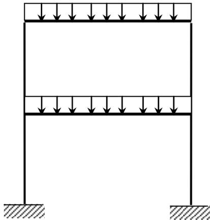
**Figure 1.5. :** Portique à deux niveaux et une travée
