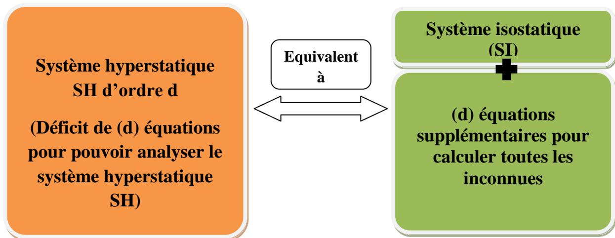
Figure 1.7. : Calcul des systèmes hyperstatiques
