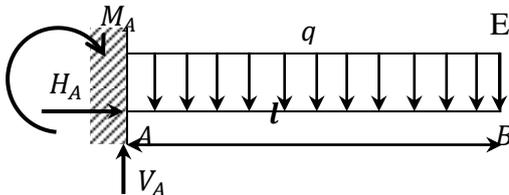
Figure 1.2. : Structure isostatique
