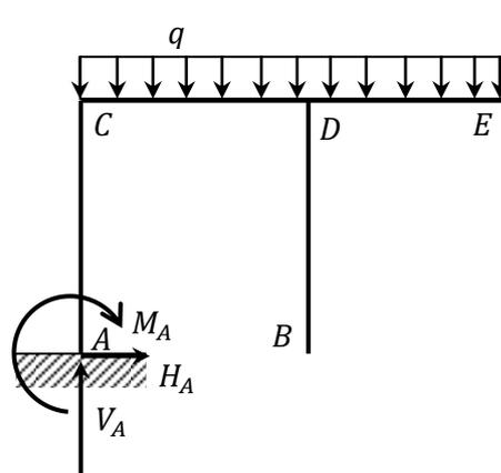
**Figure 1.6.b :** Portique isostatique
