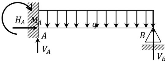
Figure 1.3. : Structure hyperstatique
