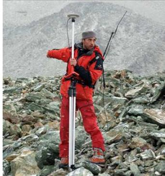
Fig. 5. Mesures du déplacement de terrain par GPS.
