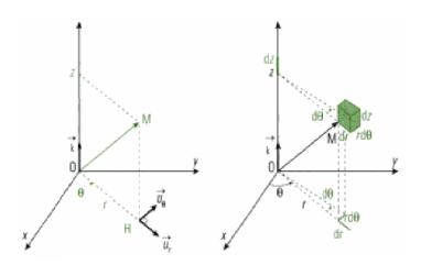
si le mouvement du point M est circulaire dans le plan (XOY) et translate suivant l'axe (OZ) on repère la position M par les coordonnées cylindriques  $(r, \theta, z)$ .
