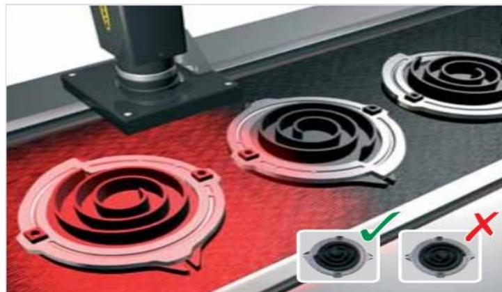
**Figure 1.5:** Vérification d'orientation
