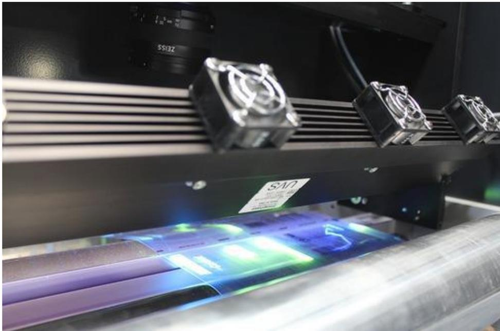
**Figure 1.7 : caméras linéaires, en fonction de la largeur du matériau à inspecter, avec des vitesses allant jusqu'à 350 mètres de ruban par minute, avec une détection des défauts jusqu'à 0,02 mm<sup>2</sup>.**
