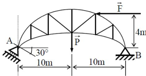
التمرين 3: ليكن القوس المجمع الموضح في الشكل ، يرتكز عند B على مسند ثابت وعند A على مسند متحرك والذي يصنع زاوية  $30^\circ$  مع المستوى الأفقي. الوزن الذاتي للقوس هو  $P = 100KN$ . القوة  $F$  لضغط الرياح تساوي  $20 KN$  ، ويتم تطبيقها على ارتفاع  $4$  أمتار فوق النقطة B.
