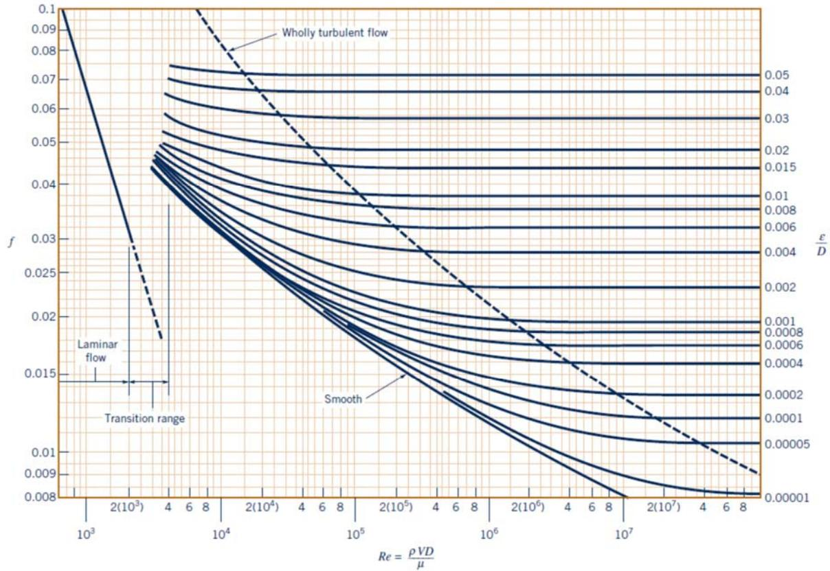
هذه الخرائط لا تعطي المعامل بدقة كبيرة، حيث ان خطأ 10 بالمائة يعتبر مقبولاً. للتقليل من الخطأ، يمكن إيجاد معامل الاحتكاك عن طريق الحساب باستخدام بعض العبارات الناتجة عن التجربة كمعادلة كولبروك *Colebrook* التي تستخدم في حالة الجريان المضطرب والتي تكتب:
