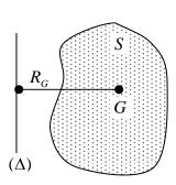
Soit S la surface et  $R_G$  la distance de son centre d'inertie à  $(\Delta)$  .
