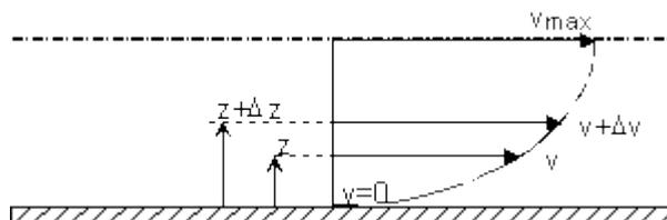
Si on représente par un vecteur, la vitesse de chaque particule située dans une section droite perpendiculaire à l'écoulement d'ensemble, la courbe lieu des extrémités de ces vecteurs représente le profil de vitesse.
