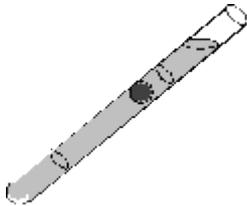
Une bille sphérique tombe lentement dans un tube bien calibré renfermant le liquide visqueux. On mesure la durée  $t$  que met la bille pour parcourir une certaine distance. On montre que la viscosité dynamique  $\eta$  est proportionnelle à la durée  $t$  :  $\eta = K \cdot t$
