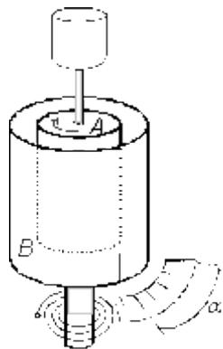
Un cylindre plein (A) tourne à vitesse constante dans un liquide contenu dans un récipient cylindrique (B) ; celui-ci, mobile autour de son axe de révolution, est entraîné par le liquide. Un ressort, exerçant un couple de torsion après avoir tourné d'un angle  $\alpha$ , retient (B) en équilibre.
