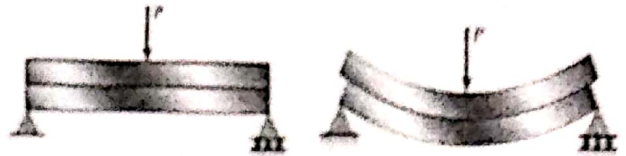
Phénomène de cisaillement dû à la flexion
