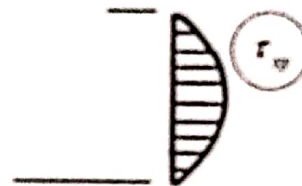
Distribution des contraintes tangentielles dans une section droite rectangulaire
