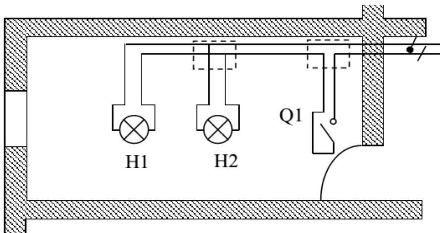
C. Schéma unifilaire
