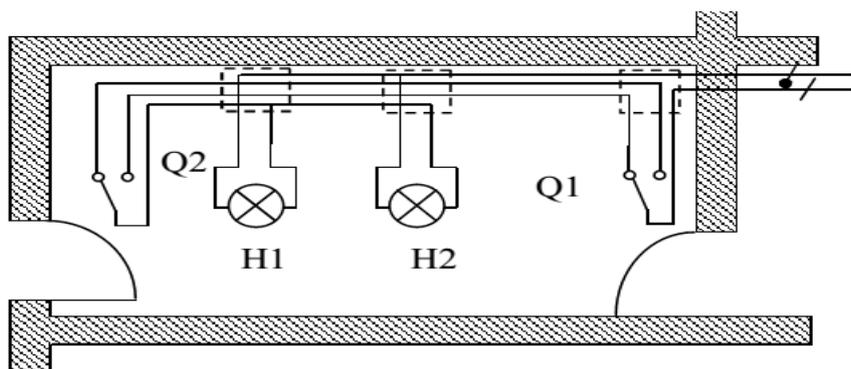
C. Schéma unifilaire
