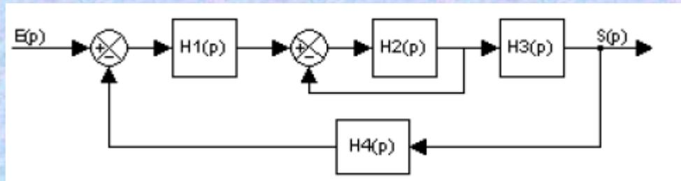
$$H(p) = \frac{H_1(p)H_2(p)H_3(p)}{1 + H_2(p) + H_1(p)H_2(p)H_3(p)H_4(p)}$$
