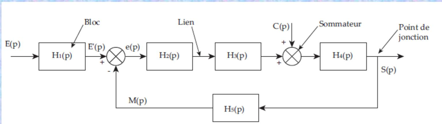
Dans le but de réaliser *l'analyse* et la *synthèse* d'un système asservi, il apparaît intéressant de représenter chaque bloc fonctionnel par sa transmittance (son modèle mathématique).
