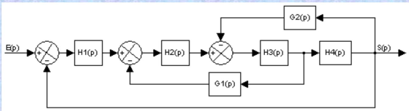
$$H(p) = \frac{H_1(p)H_2(p)H_3(p)H_4(p)}{1 + G_2(p)H_3(p)H_4(p) + G_1(p)H_2(p)H_3(p) + H_1(p)H_2(p)H_3(p)H_4(p)}$$
