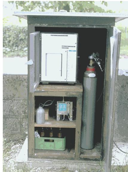
Fig. 2 - Limnigraphe pneumatique
