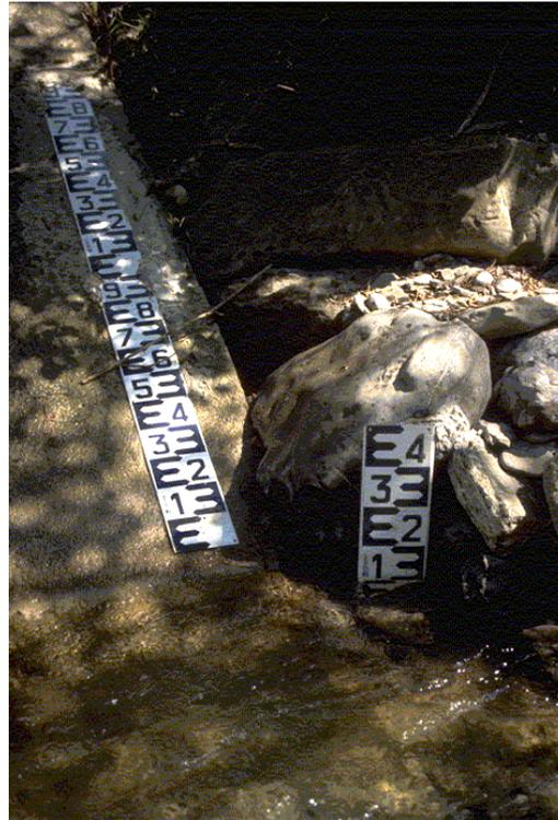
Fig. 1. - Echelles limnimétriques inclinée et verticale.
