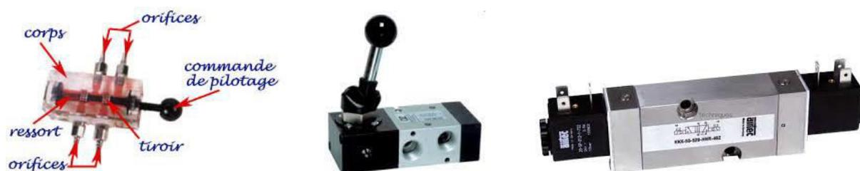
Les distributeurs courants ont 2 ou 3 positions et entre 2 et 5 orifices et ils sont désignés par ces paramètres : nombre d'orifices / nombre de positions. Ainsi un distributeur 5/2 comporte 5 orifices et 2 positions.
