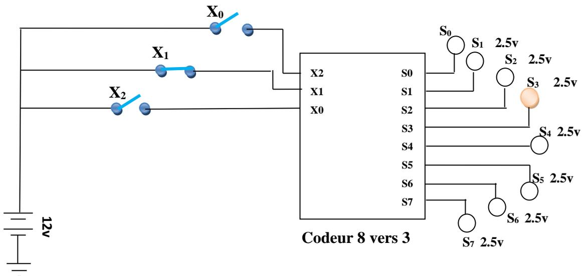
A partir de ce montage électronique réalisé sur la plaque d'essai, vérifier les équations logiques citées précédemment.
