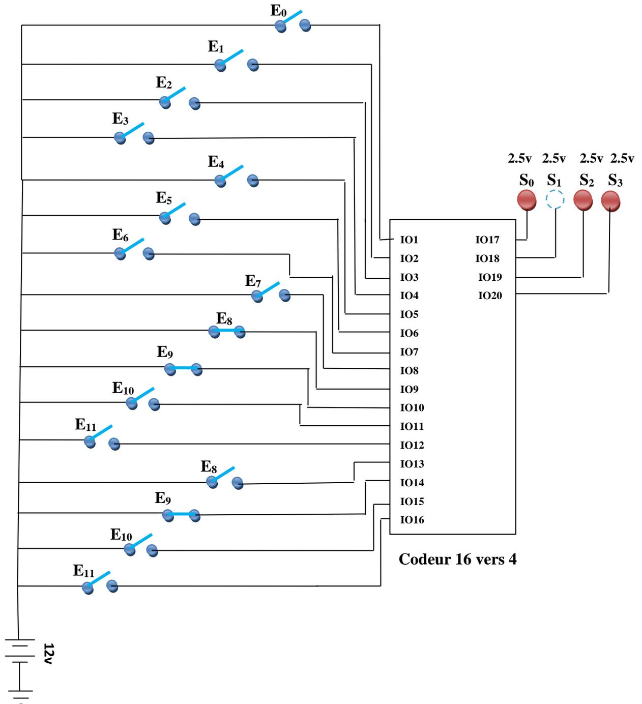
A partir ce montage électronique réalisé sur la plaque d'essai, vérifier les équations logiques citées précédemment.
