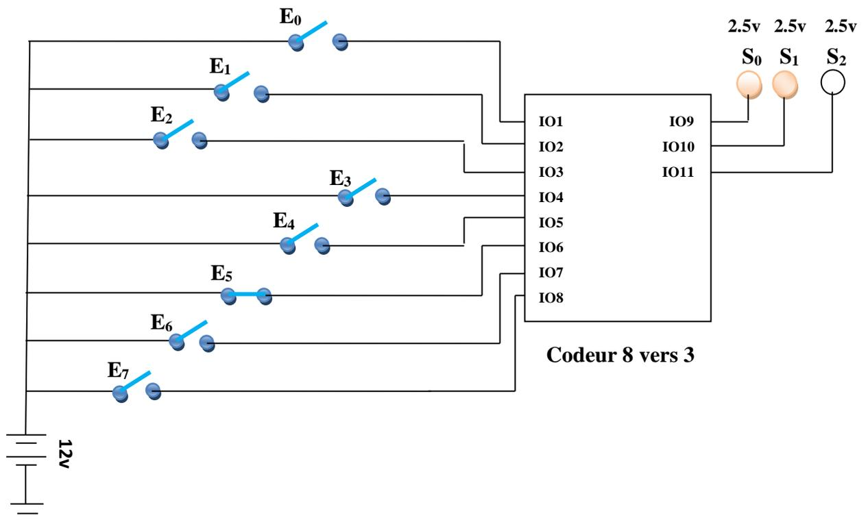
A partir ce montage électronique réalisé sur la plaque d'essai, vérifier les équations logiques citées précédemment.
