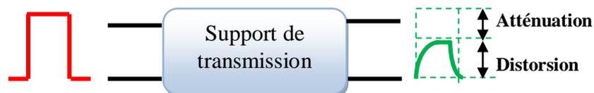
Figure 20. Déformation du signal par le support de transmission
