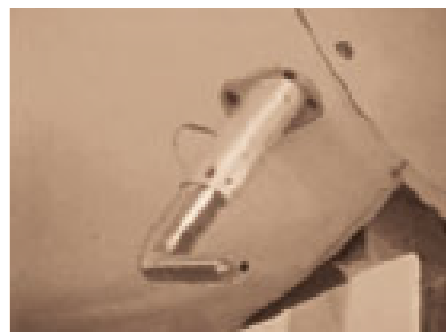
Tube de Pitot dans un avion
