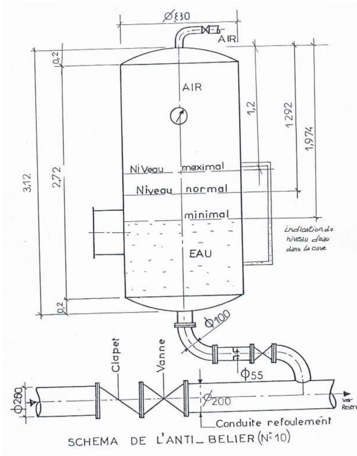
Figure XI.5 Schéma d'un réservoir anti-bélier
