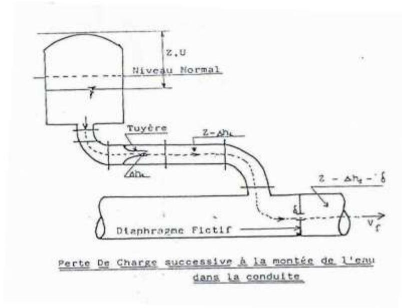
Figure XI.1 Perte de charge successive à la montée de l'eau ans la conduite
