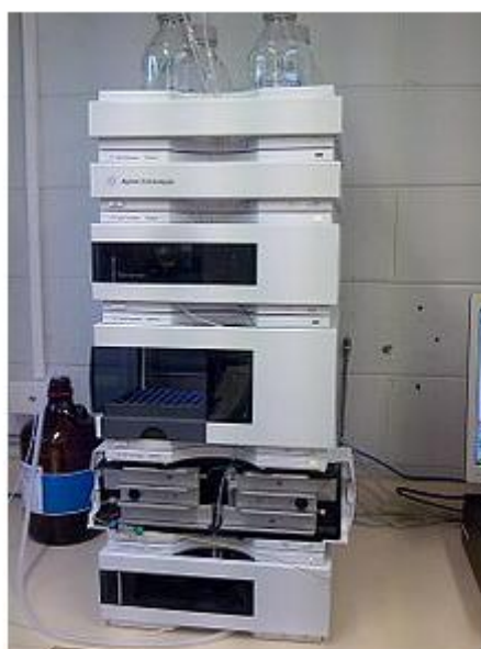
Fig.1 : Schéma d'une installation de CLHP avec double détection. Un exemple de réalisation de type modulaire.
