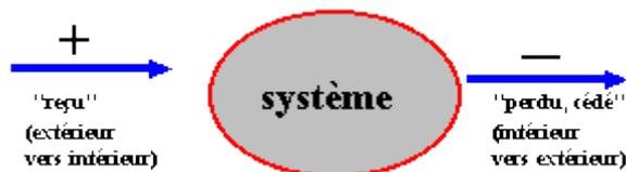
Fig3. Système thermodynamique
