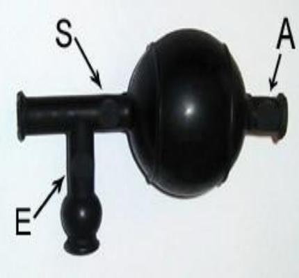
La propipette s'utilise avec une pipette graduée ou une pipette jaugée. Elle permet d'aspirer pour faire monter le liquide dans la pipette, de maintenir ou de laisser couler ce liquide.
