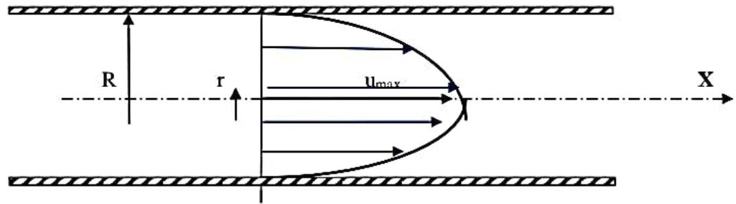
**Figure (4.5) :** Répartition des vitesses dans la conduite.
