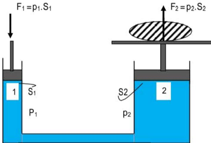
**Figure.2.3 :** Principe d'une presse hydraulique
