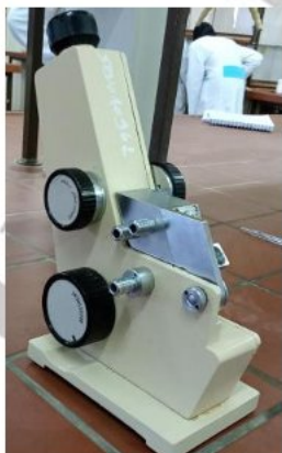
Figure VI-1.2 : Réfractomètre d'Abbe (Ancien modèle) « laboratoire univ-Oeb »
