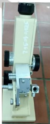
Figure VI-1.2 : Réfractomètre d'Abbe (Ancien modèle) « laboratoire univ-Oeb »
