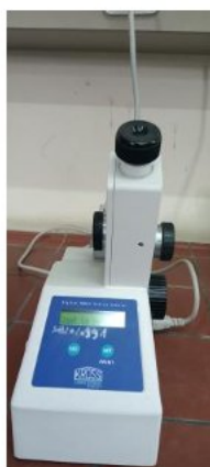
Figure VI-1.2 : Réfractomètre d'Abbe digital (KRÜSS) « laboratoire univ-Oeb »
