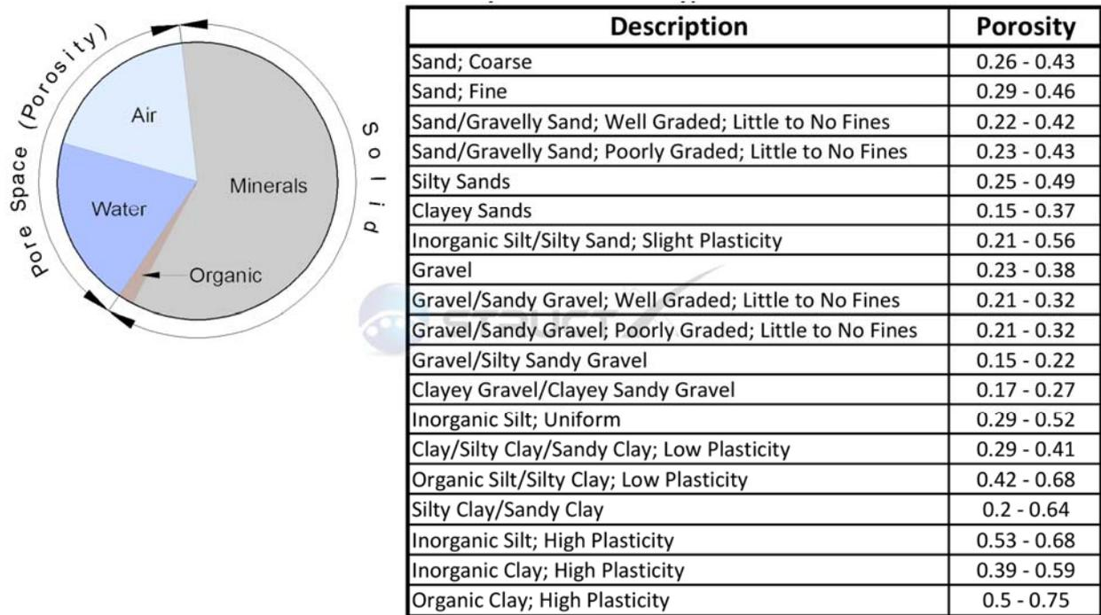
Figure-2.7 : Porosité de quelques types de roches [9]
