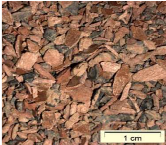
Déblais de forage
