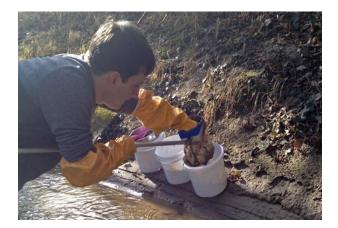
L'échantillonnage s'effectue de manière différente selon le milieu, en particulier selon la nature du sédiment et la hauteur d'eau. On utilise notamment ceux qui sont la dans utilisés norme **IBGN** échantillonneur/haveneau, NF T 90- 350), convenir peuvent pour prélever des oligochètes
