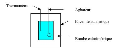
• Recherche de la masseéquivalente en eau d'un calorimètre ou des a capacité calorifique
