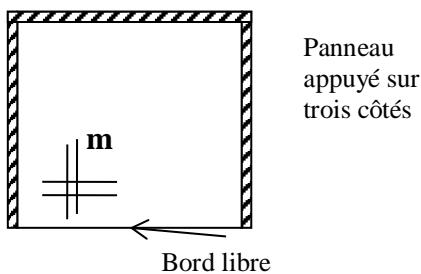
Dans ce cas nous avons deux mécanismes de ruine possibles (*voir figure suivante*). L'étude du mécanisme 1 (*déjà étudié*) ne peut se réaliser  $\lambda > 0.5$ .
