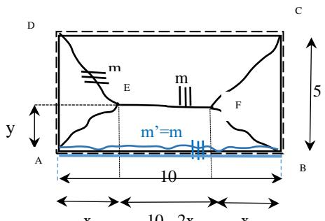
**9/** Déterminer par le biais de la méthode des lignes de rupture le moment plastique  $m$  (pour une bande de 1 mètre) d'un panneau de dalle carré de côté  $l$ , soumis à une charge uniformément répartie  $q$ .
