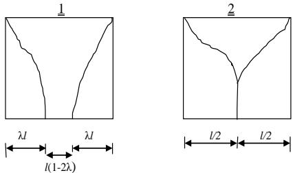
Le mécanisme 2 se compose de deux trapèzes (B) et d'un triangle (A).
