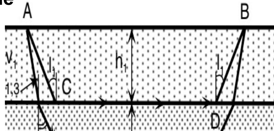
En remarquant que le dernier terme de la partie droite de l'équation devient, en remplaçant  $\frac{V_1}{V_2}$  par  $\sin l_1$ ,  $\frac{2h_1 \sin^2 l_1}{V_1 \cos l_1} = \frac{2h_1 \cos^2 l_1}{V_1 \cos l_1} - \frac{2h_1}{V_1 \cos l_1}$ , l'équation initiale devient :
